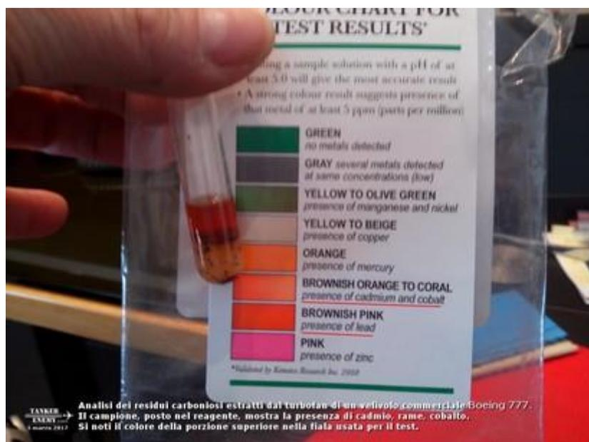
*Analisi dei residui carboniosi estratti dal turbofan di un velivolo commerciale Boeing 777. Il campione, immerso nel reagente, mostra la presenza di cadmio, rame, cobalto. Si noti il colore della porzione superiore nella fiala usata per il test e lo si confronti con la scheda di riferimento.*
